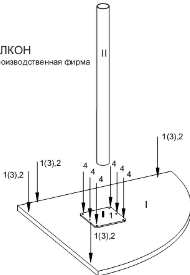
Для крепления углового элемента к столам использовать пластины крепежные (1), шурупы (2), предварительно отрегулировав высоту элемента углового при помощи регулируемой нижней части ноги. Рисунок текстуры столешницы (I) располагать согласно дизайн-проекта растановки столов.
