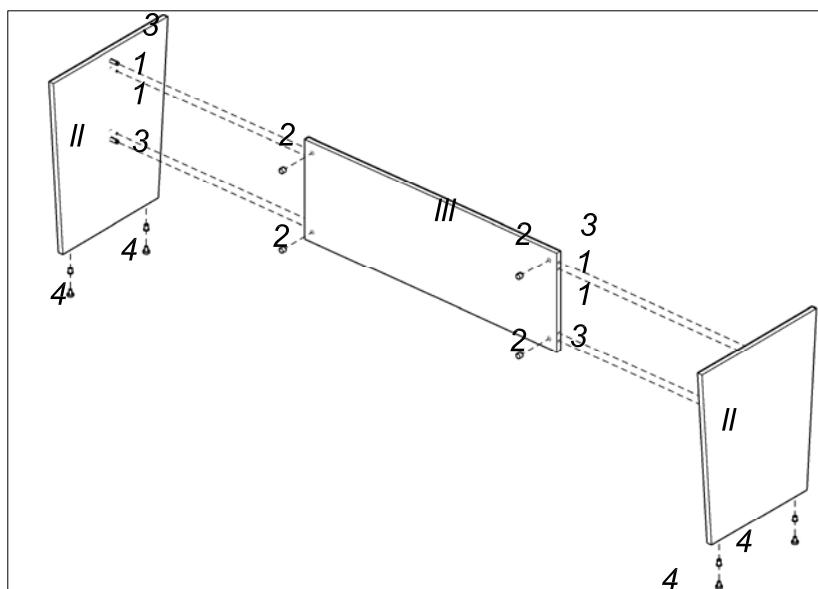
2) Стол рекомендуется собирать на столешнице. Положить столешницу отверстиями вверх. Забить в столешницу шканты (1) и вкрутить футорки (5) и дюбеля стяжек-эксцентриков (3).
